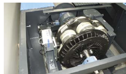
Freno de corrientes parásitas
