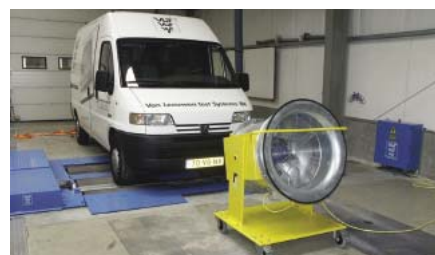
Furgoneta sobre la VLT 258950 con ventilador de refrigeración.
