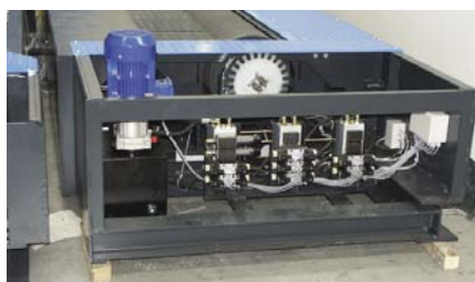
Sistema hidráulico en VLT 248950
