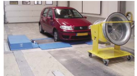
Voiture sur le VLT 148950 avec ventilateur auxiliaire de refroidissement
