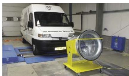
Van sur le VLT 248950 avec ventilateur auxiliaire de refroidissement
