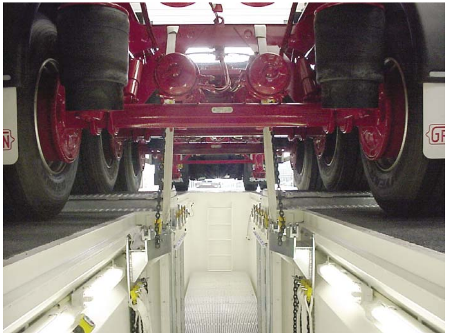
La simulation de charge en utilisant le dispositif de levage RBT
