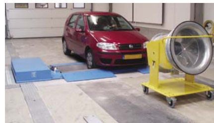
Veículo de tração no VLT 148950 + ventilador de resfriamento
